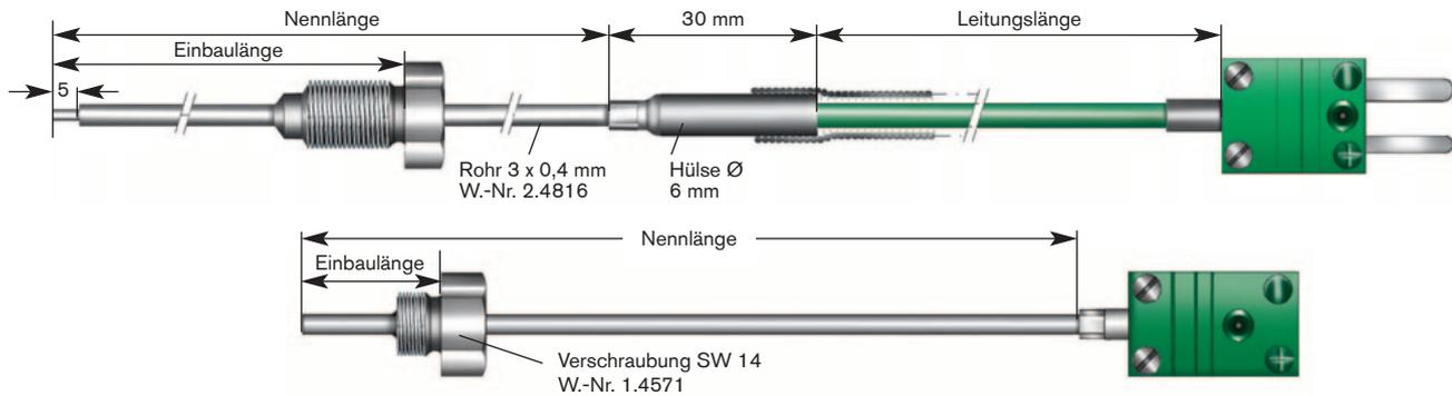
■ Thermoelement zur Temperaturmessung an Motorenprüfständen. Besonders geeignet zum Erfassen der Temperatur im Abgas-Strom am Krümmer. Das Verstärkungsrohr dient zur Erhöhung der Standzeit. Der kleine Durchmesser des Thermoelementes garantiert eine schnelle Ansprechzeit. Die Abschirmung der Leitung dient zugleich als mechanischer Schutz sowie als Schutz vor elektromagnetischen Störeinflüssen.
